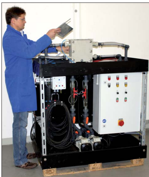
Christian Gritl erprobt an der Elektrolysezelle neue Behandlungsmethoden für Abfälle.
