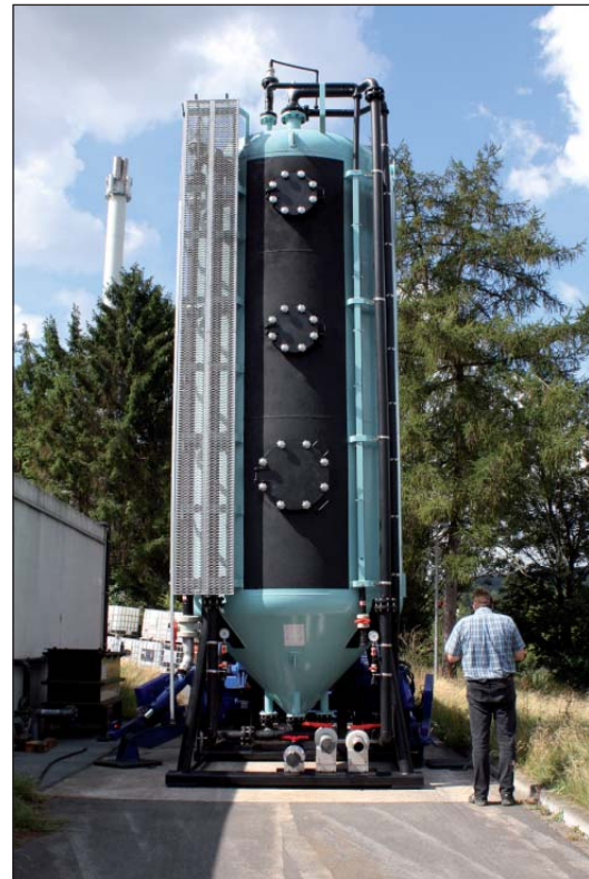
Die Aktivkohleabsorber – hier eines der neu angeschafften Exemplare direkt nach der Anlieferung – haben ein Volumen von jeweils 20 m 3 .
