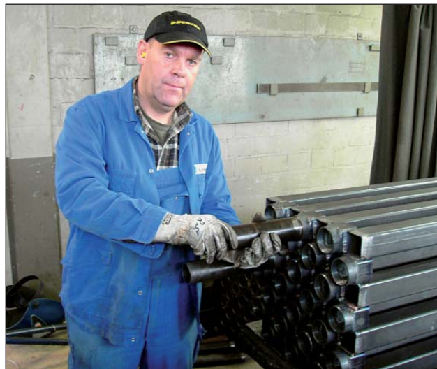
Fachmännisch verschweißte Rechteckprofil-Rohre bilden den äußerst effizienten Schlamm-Rekuperator.
